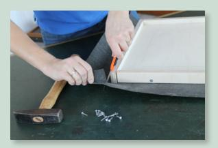
Das Dach auf die Dachpappe auflegen und an den Ecken einschneiden. Seiten umschlagen ...
