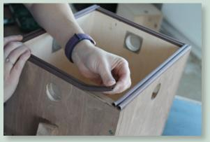
Auf der Hausoberseite wird nun rundherum die Isolierung geklebt und gleich das Dach aufgesetzt, damit sich die Klebefläche und das Holz gut miteinander verbinden können.
