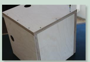
Der Boden wird eingefügt und ebenfalls festgeschraubt.
