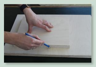
Die Bodenplatte auf die Dachplatte legen und den Umriss nachzeichnen. An drei Seiten sollte ein Abstand von ca. 5 cm sein, vorne wird ca. 14 cm Dachüberstand benötigt.
