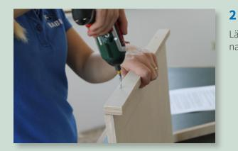
Längsleisten an das Dach anschrauben, der Überstand zeigt nach unten. Dann die Querleisten anschrauben.
